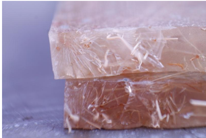
Gambar 4.15 Retakan Pada Bagian Patahan 0% MMT
