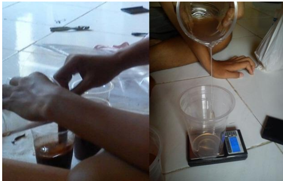
Gambar 4.6 Penimbangan Resin dan Pengadukan Adonan
