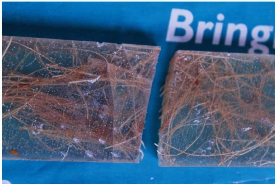
Gambar 4.14 Retakan di Daerah Patahan 0%MMT
