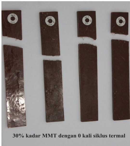
Gambar 2.4 Sample Kadar MMT 30% Setelah di Uji Tarik
