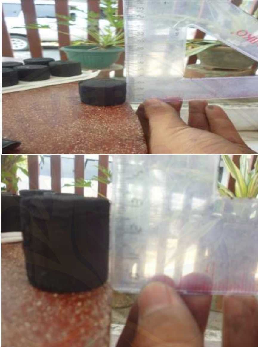
(1) Pengujian Densitas mengukur perbedaan ketinggian briket dari setiap hasil variasi tekanan.
