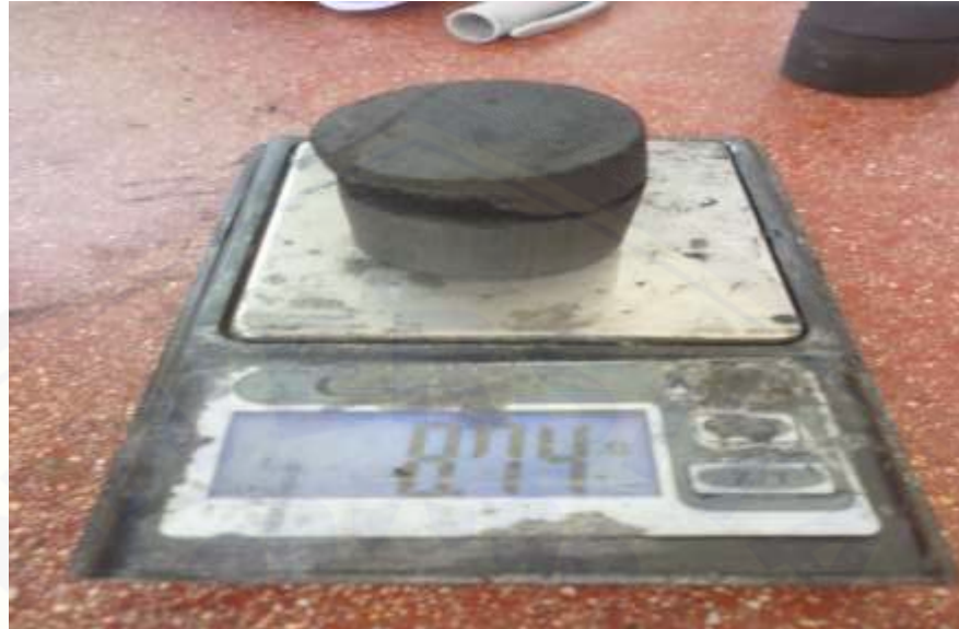
(p) Menimbang briket setelah di uji drop test
