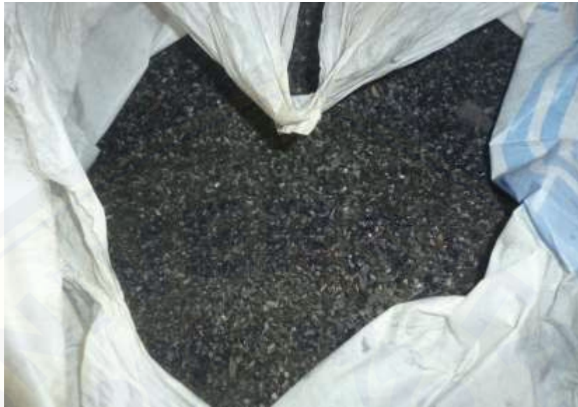
(d) Hasil Arang Yang Telah Dipirolisis dengan Temperatur 400^{\circ}\text{C}
