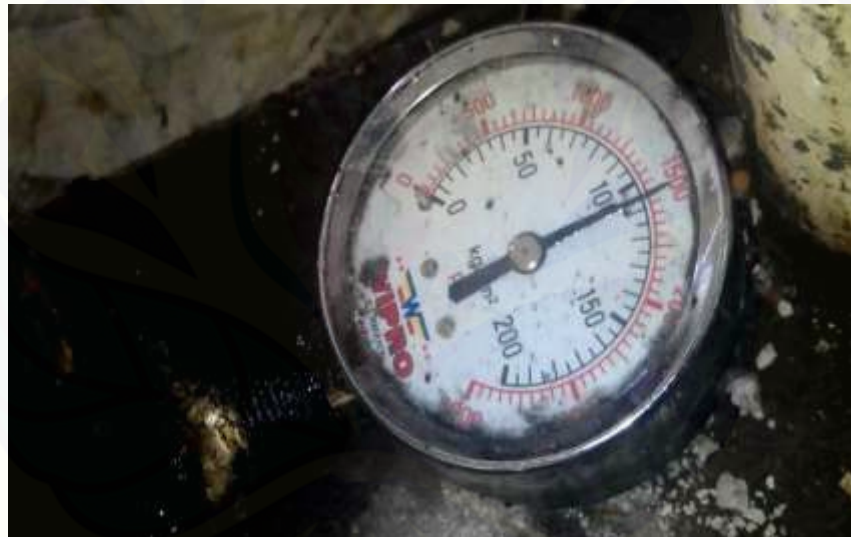
(h) Pencetakan Briket dengan Variasi Tekanan Memodifikasi dongkrak hidrolis dengan memasang pressure gauge pada tabung 1 kemudian melakukan variasi tekanan sebesar 100 kg/cm 2 .
