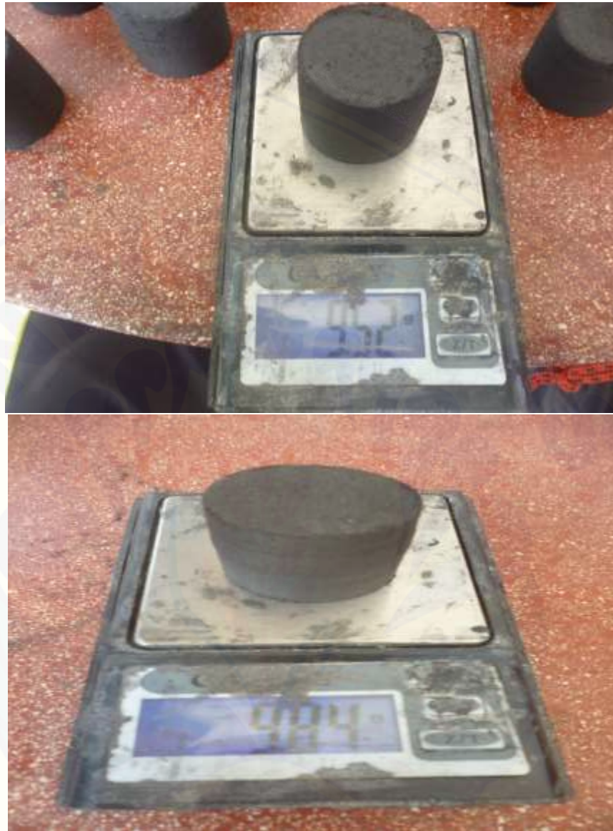
(m) Pengujian Drop Test menimbang briket sebelum dijatuhkan
