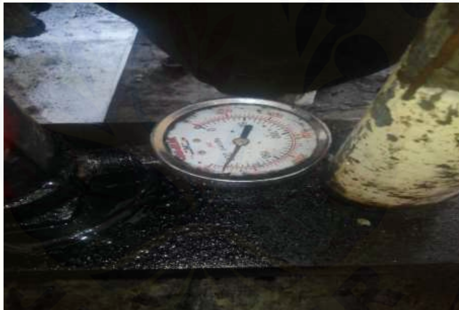
(j) Memodifikasi dongkrak hidrolik dengan memasang pressure gauge pada tabung 1 kemudian melakukan variasi tekanan sebesar 200 \text{ kg/cm}^2 .
