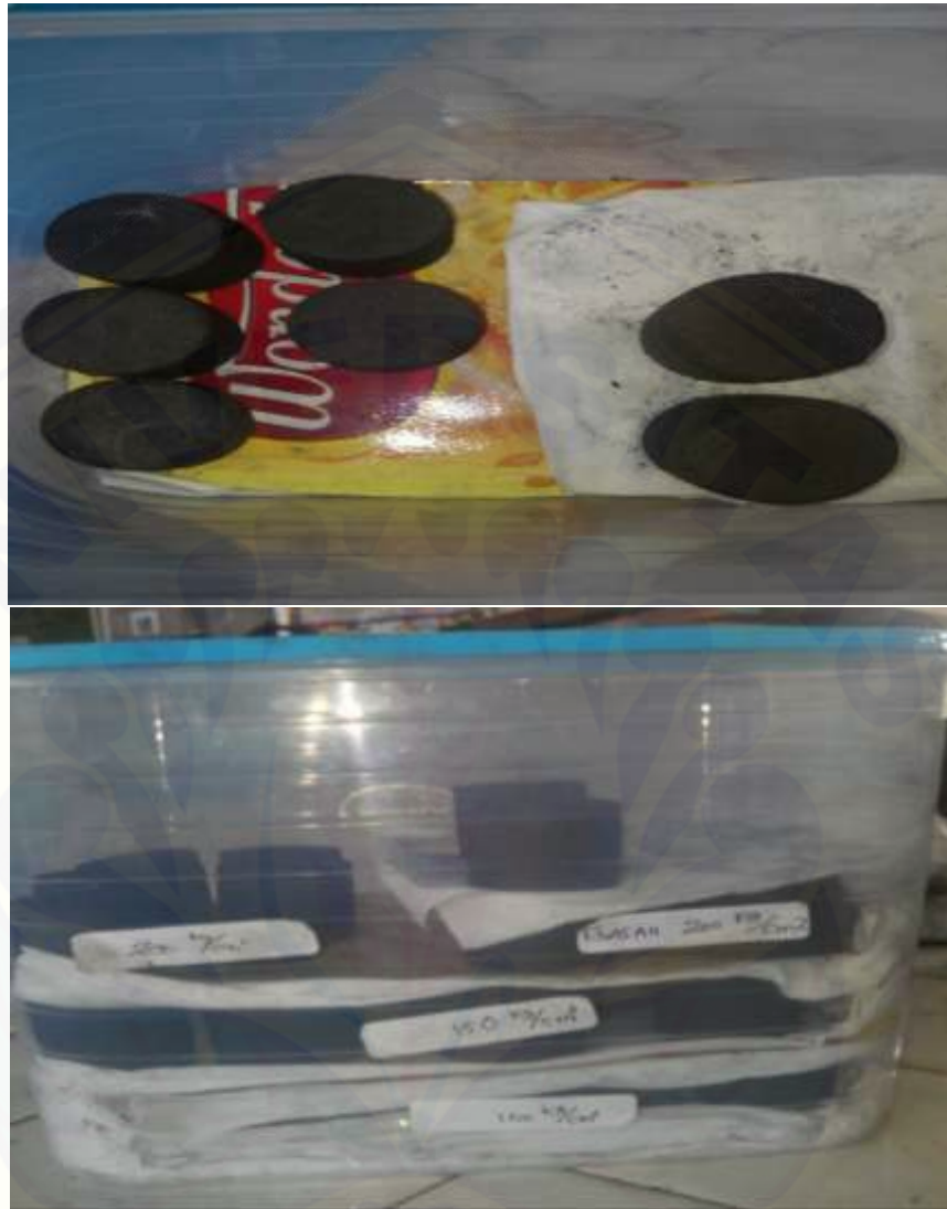
(k) Hasil pencetakan briket dengan variasi tekanan 100 kg/cm 2 , 150 kg/cm 2 , 200 kg/cm 2 .
