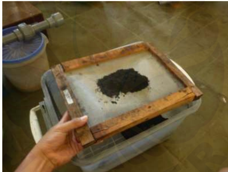
(e) Partikel Dengan Ukuran Mesh 70 Dengan Pengayaan Lolos Mesh 70 Dan Tertahan Di Mesh 60
