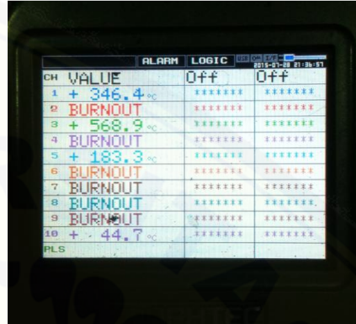
Gambar B10. Termoreader Saat Menguji Temperatur Pembakaran Sampai Temperatur Maksimum
