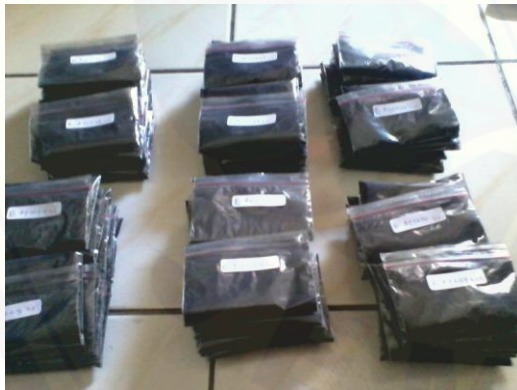
Gambar B3. Campuran Arang dan Tepung Tapioka Siap Cetak
