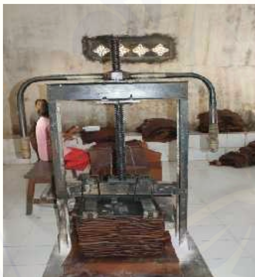
Gambar 5.1 Alat Pengepres Sheet Pabrik Kalijompo (a) Rancangan Alat Pengepres Pompa Hidrolis (b)
