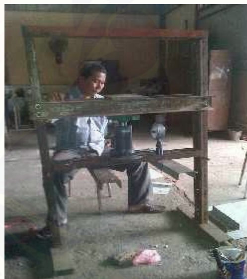
Gambar 5.1 Alat Pengepres Sheet Pabrik Kalijompo (a) Rancangan Alat Pengepres Pompa Hidrolis (b)
