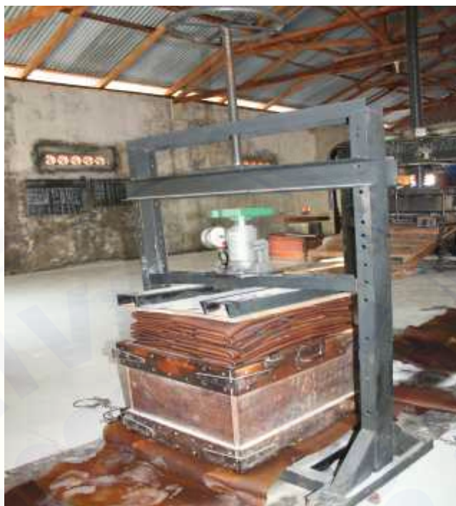
Gambar 5.7 Rancangan Keseluruhan Alat Pengepres Sheet dengan Pompa Hidrolik
