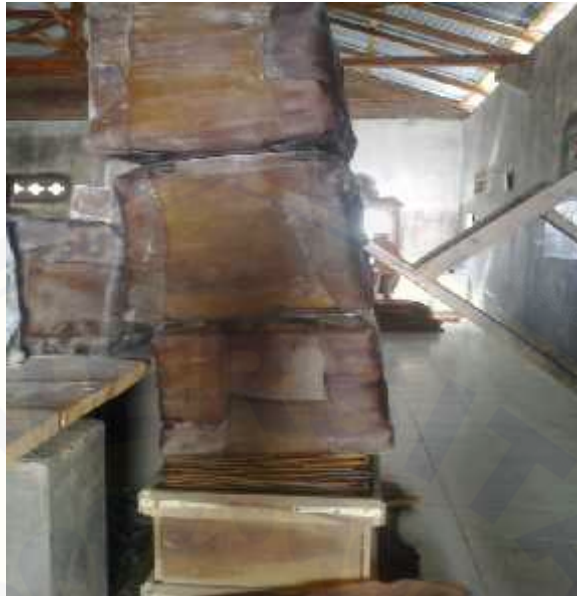
Gambar 4.1 Simulasi Pembebanan Sederhana pada Bendela Karet
