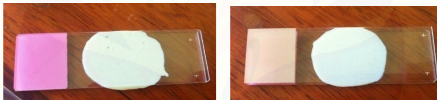
Gambar H.2 Hasil uji homogenitas setelah penyimpanan selama 30 hari (suhu kamar) (c) Formula F1; (d) Formula F2
