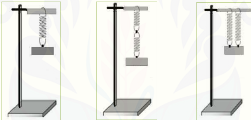
(a) Pegas tunggal (b) Pegas disusun seri (c) Pegas disusun paralel
