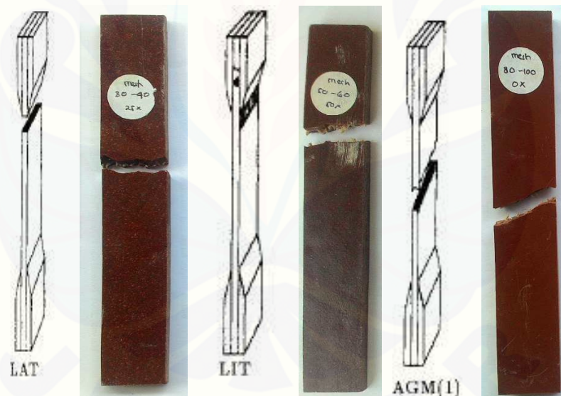
Gambar 4.13 Analisa bentuk patahan menurut ASTM D 3039 pada komposit mesh 30-40, 50-60 dan 80-100.
