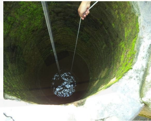
Gambar 6. Pengisian botol timba dengan sampel air
