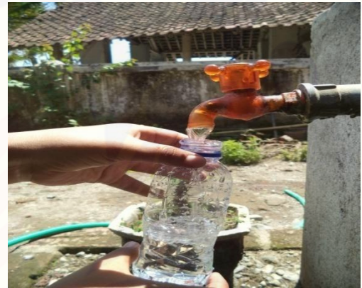
Gambar 10. Pengambilan sampel air melalui kran
