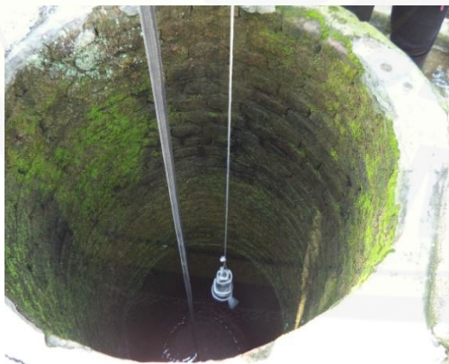
Gambar 5. Botol timba di dalam sumur
