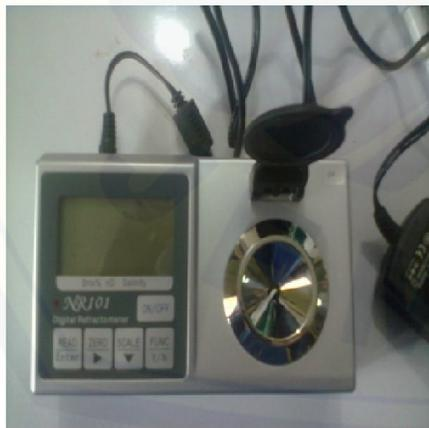
Gambar 11. Analisis brix gula menggunakan alat refraktometer
