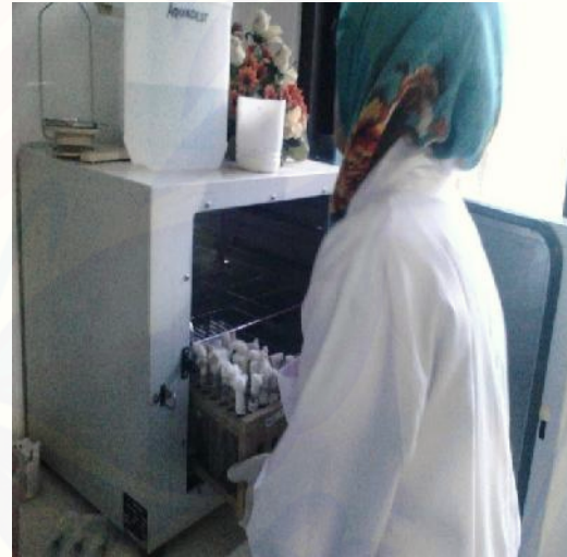
Gambar 16. Sampel di inkubasi pada suhu 35 °C - 37 °C selama 24 – 48 jam
