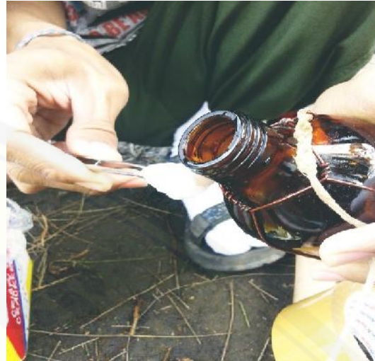
Gambar 10. Mulut botol dipanaskan kembali dan diberi etiket
