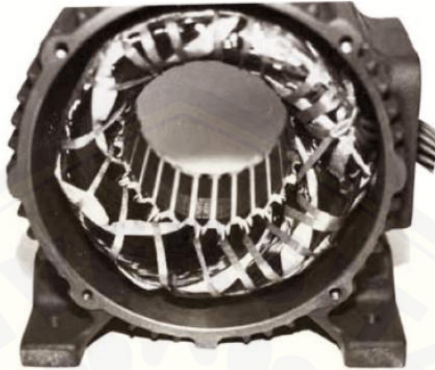
Gambar 2.5 Stator pada Mesin Induksi yang menunjukkan kumparan stator (Sumber: Chapman. 2005)
