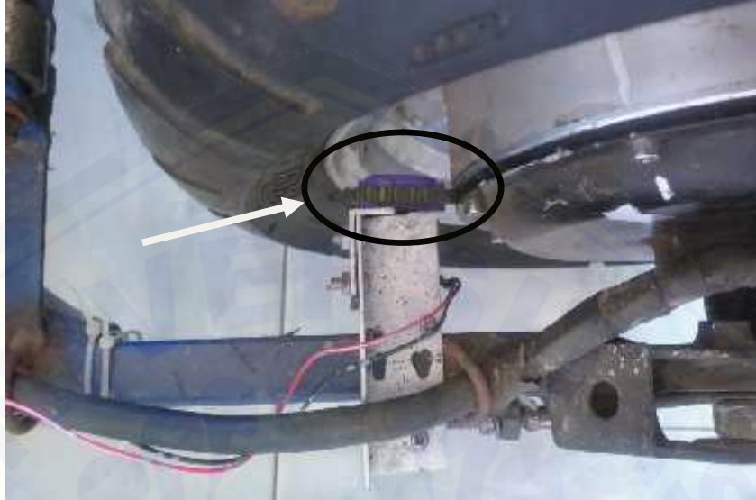
Gambar 3.3 Generator DC sebagai Sensor Kecepatan
