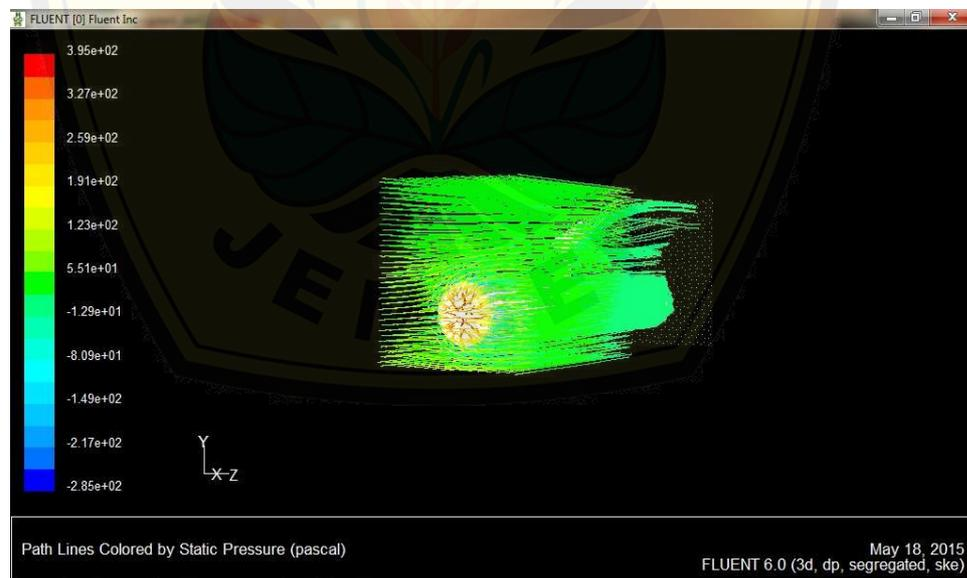
Gambar 4.10 *Path line* Sebaran Air Panas *Spray Pond* dari sisi samping dengan tekanan 13 Pascal
