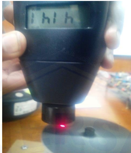
Gambar 4.6 Kecepatan Putar Motor Tegangan V_a (6 V) dan Tegangan ( V_f ) 6 V
