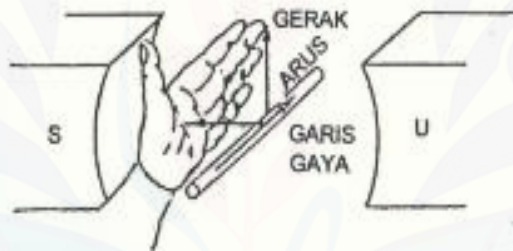
Gambar 2.2 Penentuan Arah Gaya Listrik Dalam Medan Magnet
