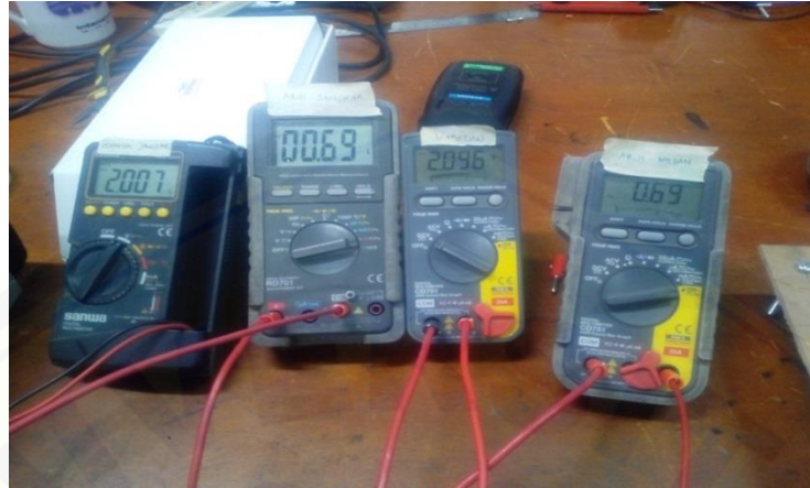
Gambar 4.1 Pengujian DC Test Pada Kumparan Jangkar dan Kumparan Medan
