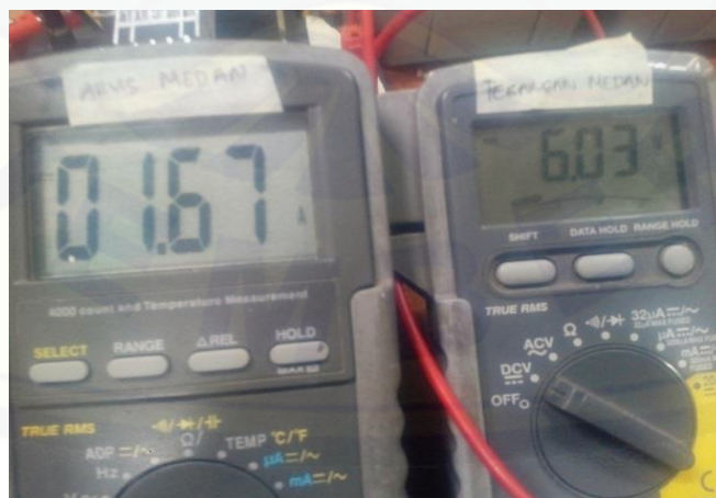
Gambar 4.5 Pengujian Tanpa Beban Pada Tegangan ( V_f ) 6 Volt
