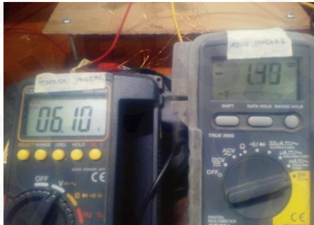
Gambar 4.4 Pengujian Tanpa Beban Pada Tegangan ( V_a ) 6 Volt
