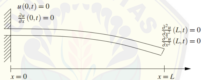
Gambar 2.1 Gerak defleksi pada beam (Sumber: Goodwine, 2011)
