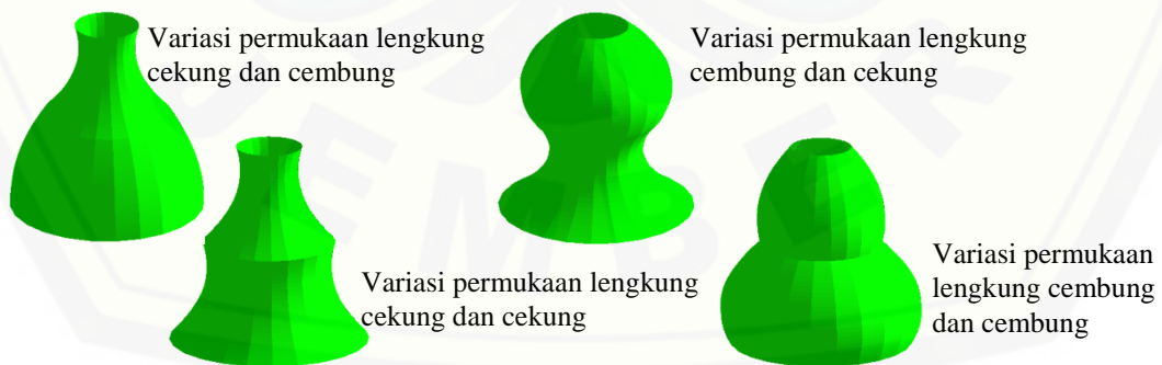
Gambar 4.19 Variasi bentuk deformasi tabung dengan modifikasi kurva selimut
