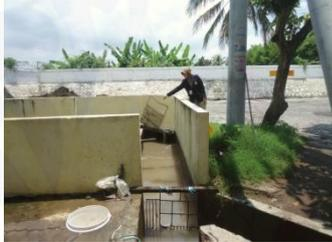
Gambar 5. Pengukuran volume limbah cair di *inlet*
