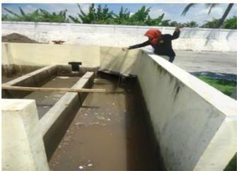
Gambar 4. Pengukuran volume limbah cair di *inlet*
