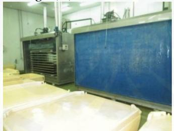
Gambar 2. Pembekuan udang menggunakan *contact plate freezer*
