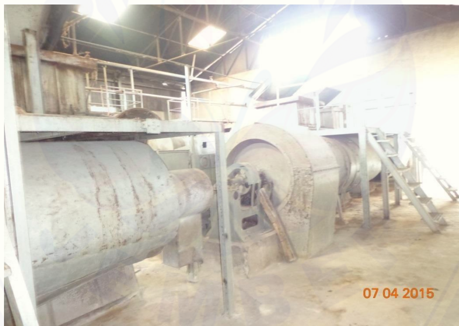
Gambar 4. Mesin Mason sebagai Pengeringan Kopi Ose
