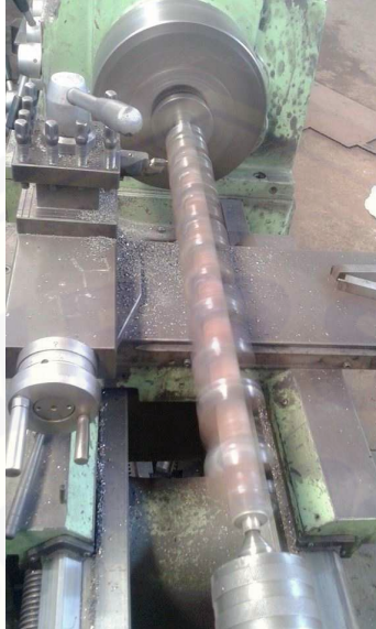
Gambar 4.2 Archimedean Screw Saat Proses Pembubutan
