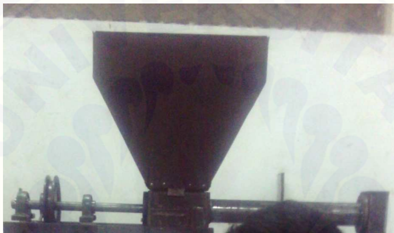
Gambar 4.10 Hopper yang sudah menempel pada body extruder
