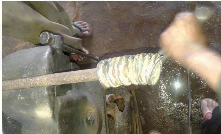
Gambar 4.6 Proses Penyatuan Poros dan Plat Screw
