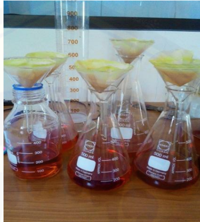
Gambar 3.4 Ekstrak kulit manggis disaring dengan kertas penyaring
