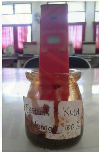
Gambar 3.7 Pengukuran pH ekstrak kulit manggis menggunakan pH meter
