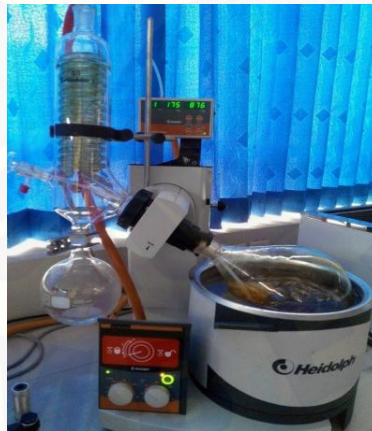
Gambar 3.5 Ekstrak kulit manggis yang dievaporasi dengan alat rotary evaporator
