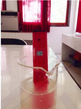
Pengukuran pH air perasan jeruk nipis
