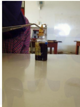
1 buah sampel dimasukkan dalam botol berisi larutan kopi
