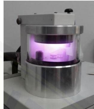
Pelapisan sampel dengan menggunakan alat *Mini Sputter Coater*, yang berfungsi untuk melapisi material yang bersifat non konduktor dengan lapisan metal.
