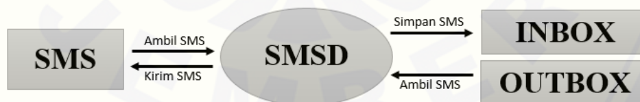
Gambar 2.3 Diagram Blok GAMMU (Sumber: Hasil Analisis, 2015)
