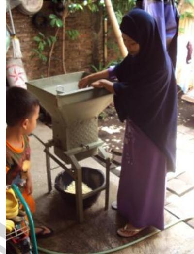
Gambar 11. Pengoperasian alat pengupas kedelai
