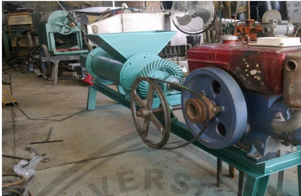
Gambar 5. Foto mesin cetak bata
