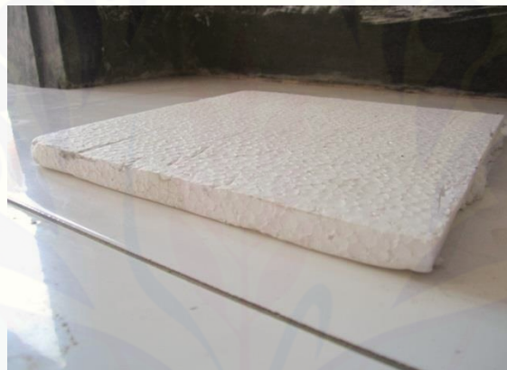
Styrofoam sebagai core
