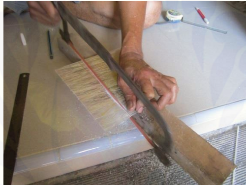
Pemotongan specimen sesuai ASTM
