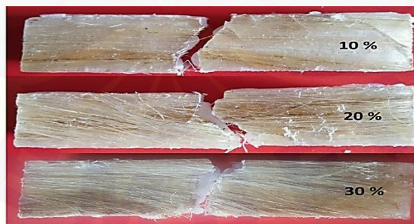
Gambar 4.5 Foto Makro Patahan Hasil Uji Impact Tebal Core 10 mm
