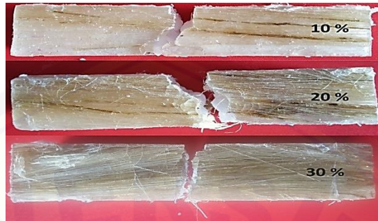
Gambar 4.6 Foto Makro Patahan Hasil Uji Impact Tebal Core 15 mm
