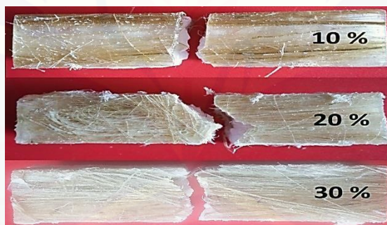
Gambar 4.7 Foto Makro Patahan Hasil Uji Impact Tebal Core 20 mm
