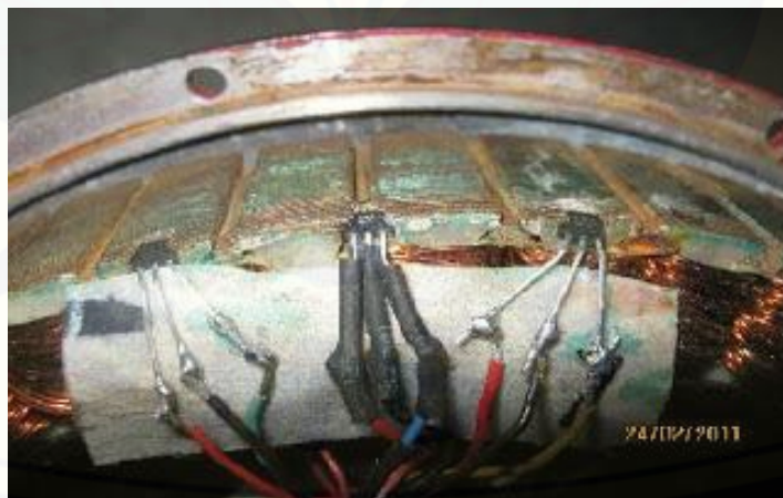
Gambar 2.10 Penempatan sensor hall pada stator
