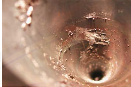
Gambar 2. 6 Korosi pada logam padat akibat proses difusi (Sumber: Niu et al , 2014)
