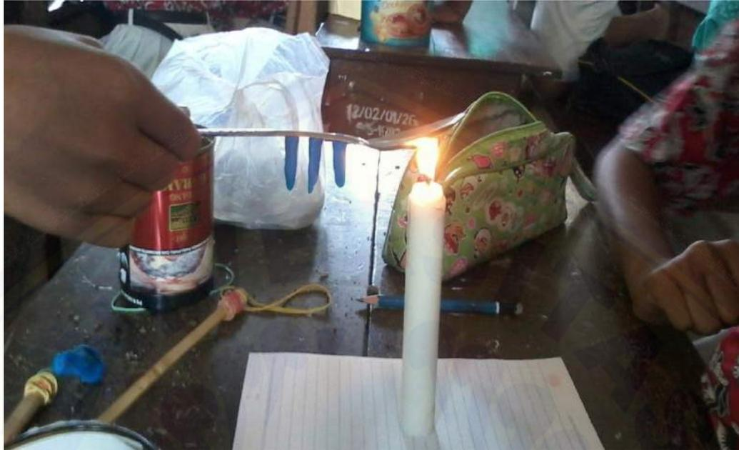
Gambar S.3 Siswa melakukan percobaan perpindahan panas secara konduksi
