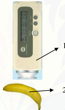
Gambar 3.6 Rancangan pengukur indeks warna pisang dengan color reader
