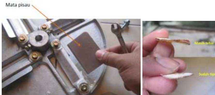
Gambar 4. Cara mengatur posisi pisau dan Standar ketebalan keripik
