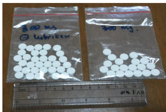
Gambar 3. Tablet dengan bahan pengisi pati singkong termodifikasi
