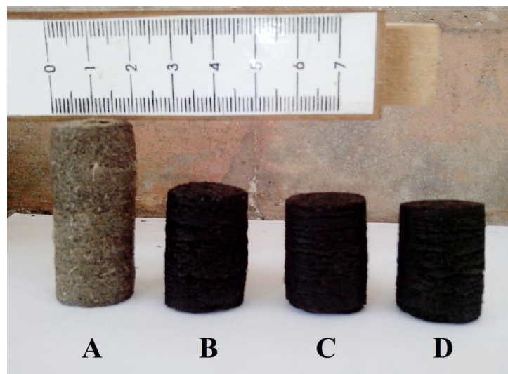
Gambar 3. (a) Briket Tanpa pirolisis, (b) Briket Temperatur pirolisis 210 0 C, (c) Briket Temperatur pirolisis 300 0 C, (d) Briket Temperatur pirolisis 390 0 C
