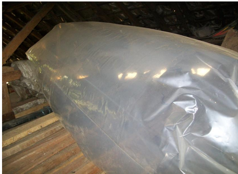
Gambar 19. Tabung Reaktor Berisi Biogas
