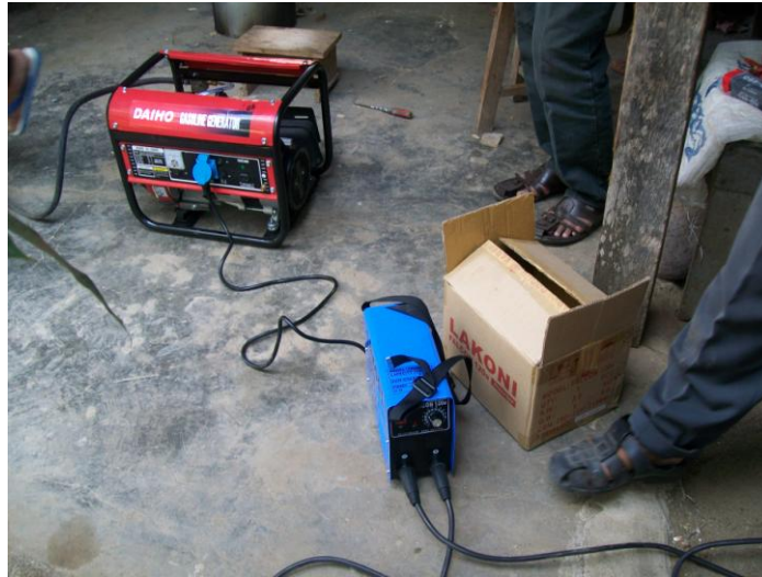
Gambar 22. Instalasi Las Listrik dengan Memanfaatkan Jensek Berbahan Bakar Biogas
