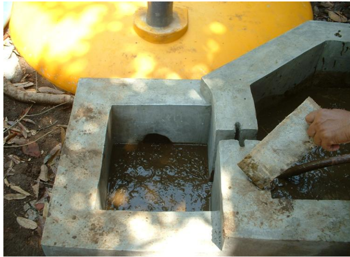
Gambar 18. Memasukkan Kotoran Ternak Sapi ke Reaktor
