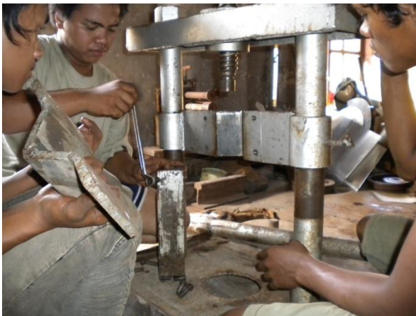
Proses Assembling Mesin Powerpress
