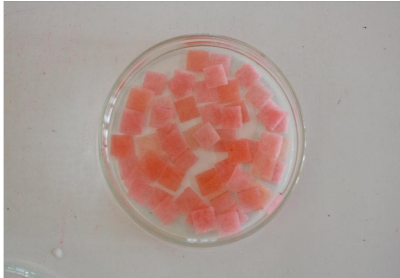
Gambar E.1 Plat resin akrilik (10x10x1mm) yang direndam saliva steril selama 1 jam
