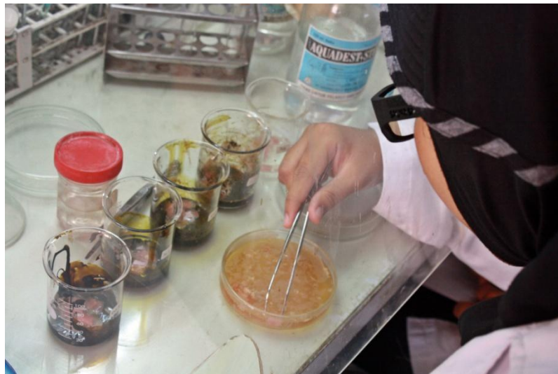
Gambar E.4 Plat akrilik dimasukkan ke dalam ekstrak daun jambu mete (konsentrasi 25%, 50%, 75%, dan 100%) aquades steril
