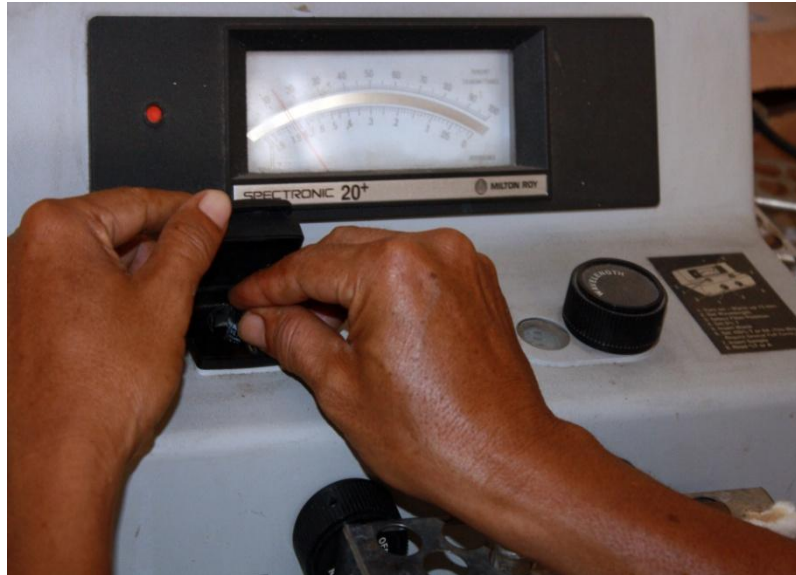
Gambar E.7 Perhitungan jumlah C. albicans menggunakan spektrofotometer
