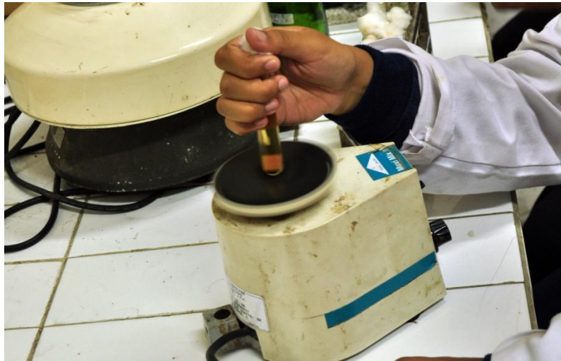
Gambar E.6 Dilakukan vibrasi selama 30 detik dengan menggunakan Thermolyne
