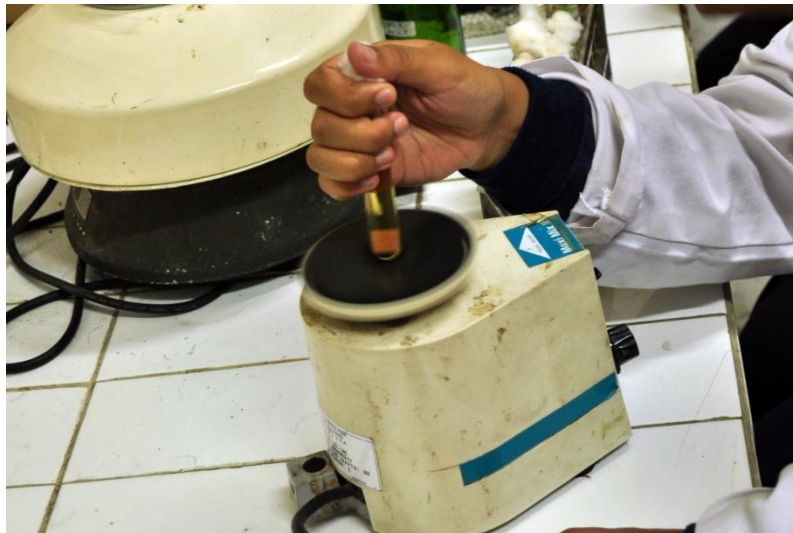
Dilakukan vibrasi selama 30 detik dengan menggunakan Thermolyne
