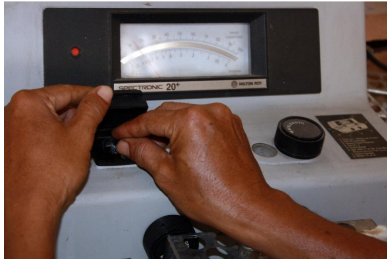
Perhitungan jumlah C. albicans menggunakan spektrofotometer
