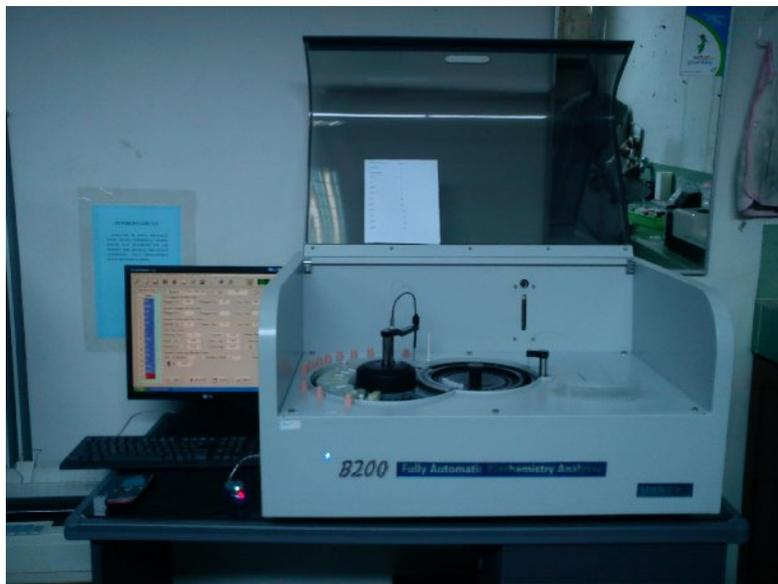
Gambar F10. Alat yang digunakan untuk membaca hasil pemeriksaan glukosa
