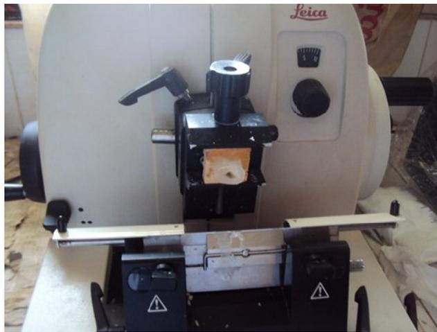
Gambar D.6 Mikrotom (Leica RM 2135)
