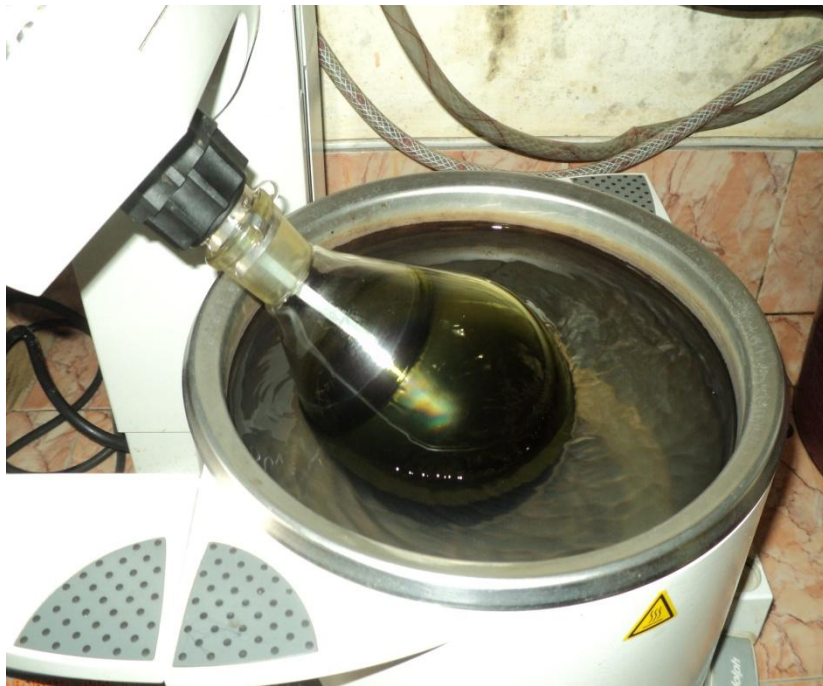
Gambar G.4. Pemekatandenganrotavapatorpadasuhu48° C
