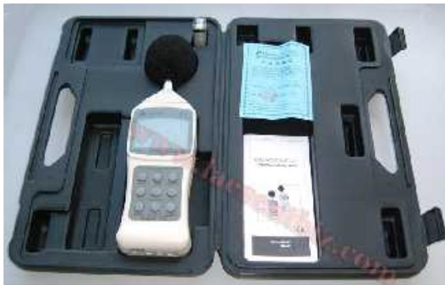
Gambar 3.3 Perangkat Sound Level Meter
