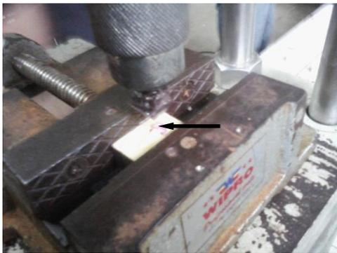
Gambar 3.7.3.1 Spesimen yang siap diuji kekuatan tekan (tanda panah)
