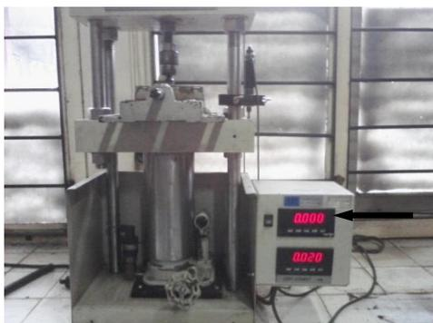
Gambar 3.7.3.3 Besar gaya yang diberikan pada spesimen yang tercatat pada papan digital (tanda panah)
