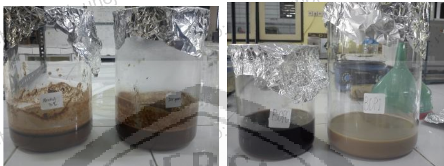
Gambar D.4 Ekstraksi Biji Kakao terserang P. palmivora (a) Proses Maserasi; (b) Ekstrak Kaya Polifenol hasil Ekstraksi
