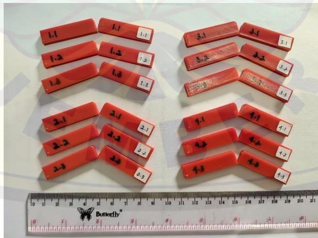
Gambar 4. 3 Spesimen Setelah Pengujian Impact
