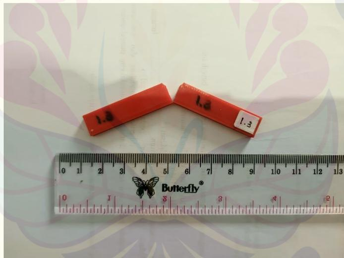
Gambar D.1 Spesimen Setelah Uji Impak
