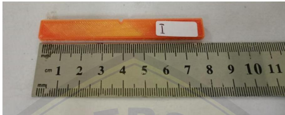
Gambar 5.1 spesimen uji impak charpy ISO-179
