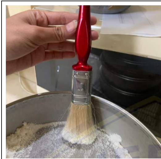
Pengayakan 80 Mesh (Distribusi Ukuran 10 – 100 Mesh)
