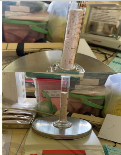
Pengukuran Densitas Curah
