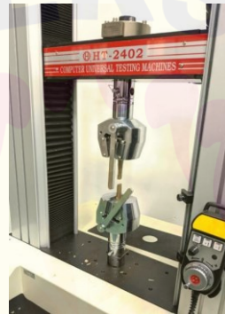
Gambar 2. 5 Skema uji tarik (Diana et al. , 2020)
