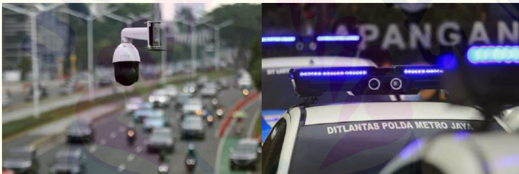
Gambar 2. 6 CCTV ETLE Lalu Lintas dan ETLE Mobile
