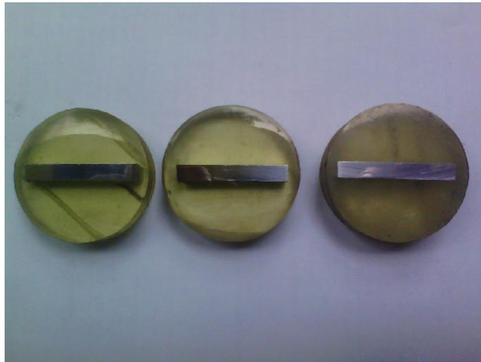
Lampiran C2. Spesimen Uji Kekerasan dan Strukturmikro
