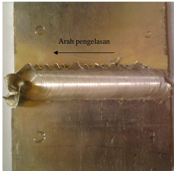
Gambar 4.1 Hasil pengelasan *friction stir welding*
