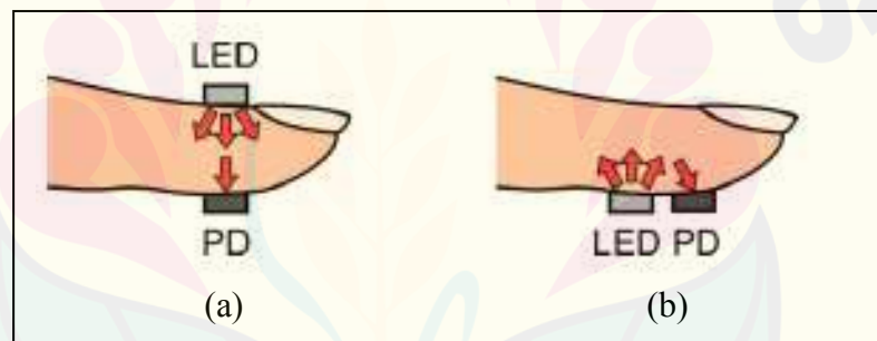
Gambar 2.2. Ilustrasi jenis PPG (a) Transmitif (b) Reflektif (Tamura et al., 2014)
